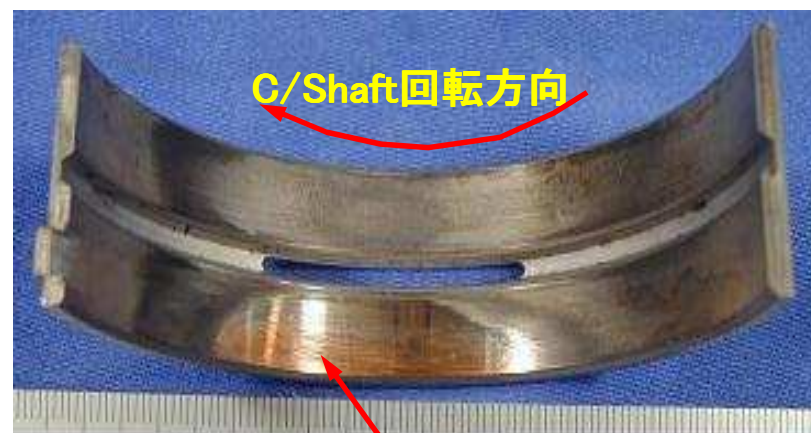
SME20%試験後の軸受面状態
