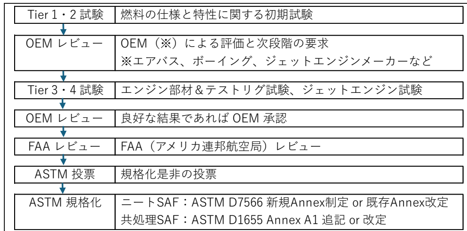
図 1 ASTM D4054 : 新規ジェット燃料の認証プロセス概要
